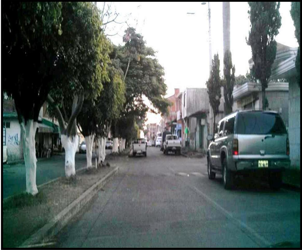
Figura 3.11. En esta imagen se aprecia los camellones con guarnición en mal estado, medidas incorrectas, así como parte de la calle que se encuentra con pavimento de concreto hidráulico, falta de topes y señalamientos de tránsito.
