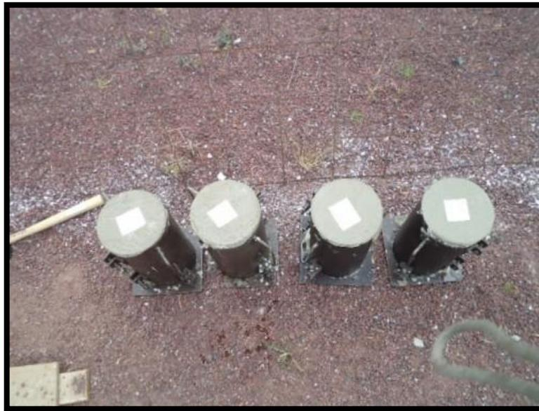
Figura 2.28 Cilindros para pruebas de concreto.
