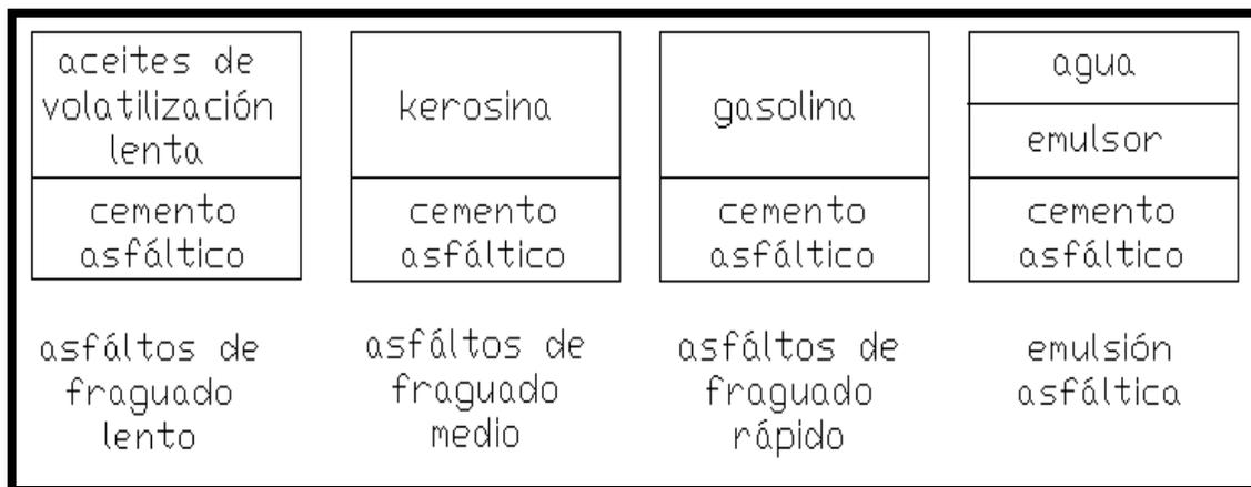
Figura 2.23 Tipos de productos asfálticos líquidos.
