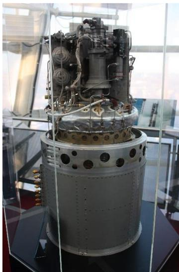
Figura 2. Celda de combustible utilizada en el programa espacial Apolo (1969). <sup>[1]</sup>
