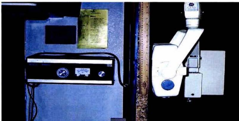
Imagen 7 Aparato de rayos x control, mampara de protección y cabeza del aparato
