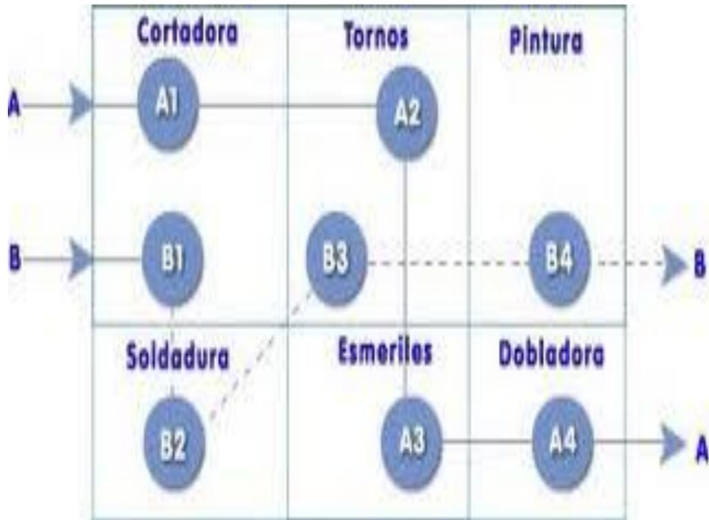
Figura 1.9 Ejemplo de un proceso intermitente.
