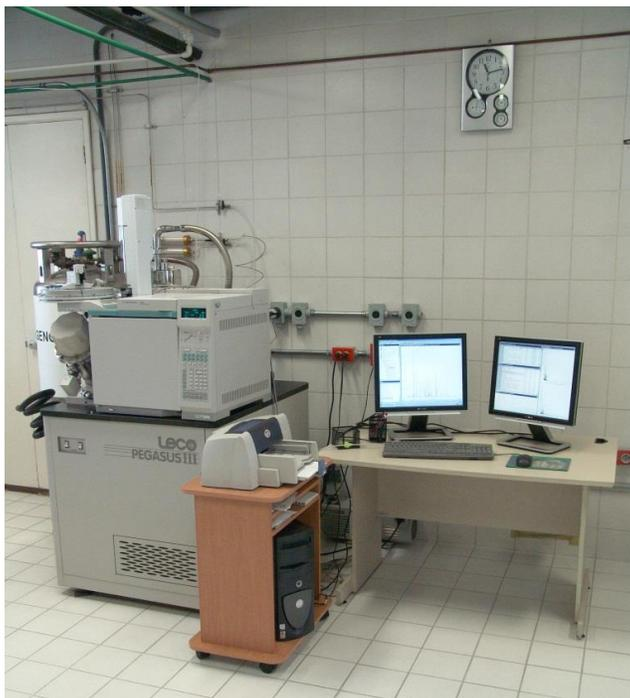
**Figura 8.** Equipo acoplado CG-EM-TOF utilizado (Unidad de Servicios de Apoyo a la Investigación, Facultad de Química, UNAM).
