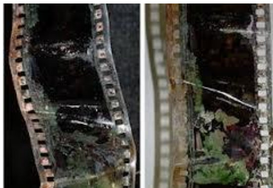
Figura 2.7. Película humedecida por el ácido acético.
