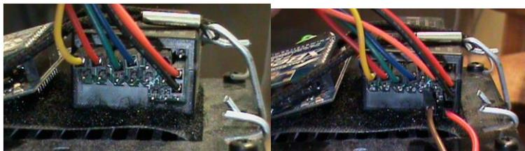
Figura 75. Conexión para entrar al modo de Sincronización del receptor Spektrum AR7000
