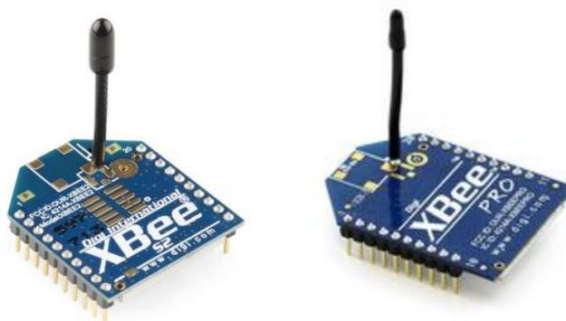
Figura 18. Tarjetas de Telemetría Xbee y Xbee Pro
