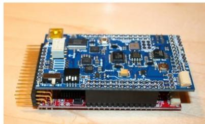
e) Resultado final de los Headers hembra soldados y la tarjeta ya ensamblada.
