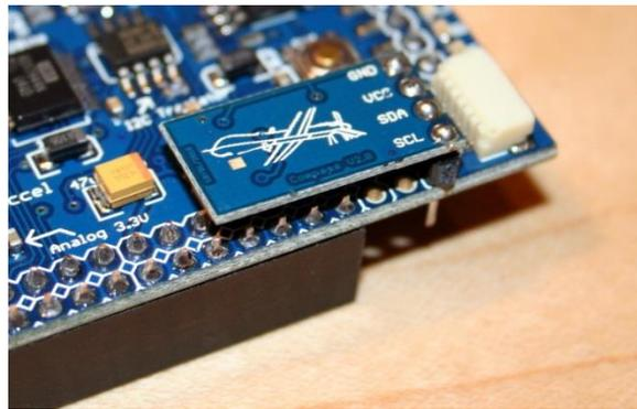
c) Magnetómetro colocado en la tarjeta APM 1 IMU Shield
