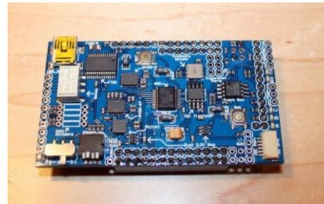
d) Colocando la tarjeta APM 1 IMU Shield sobre los headers hembra
