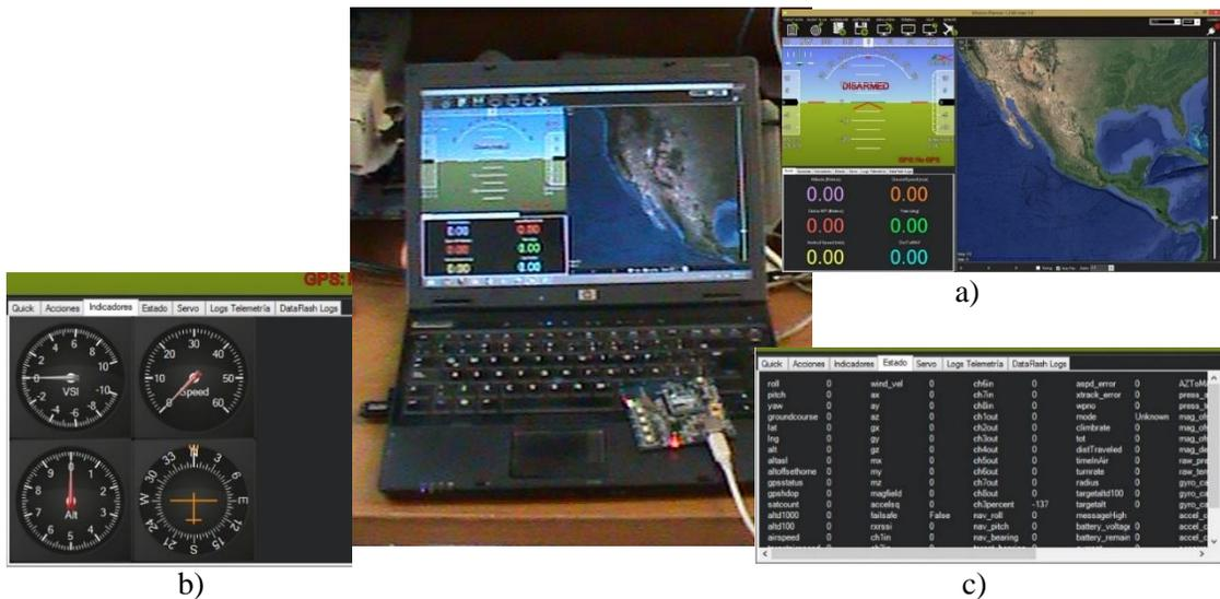
Figura 62. Pantalla Principal de Datos de Vuelo y sus diferentes opciones. Mission Planner a) Instrumentos de vuelo, b) Instrumentos de navegación, c) Paramentos recibidos
