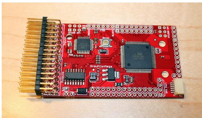
Figura 89. Heder de ángulo recto 3x16, colocado en tarjeta ATmega 2560
