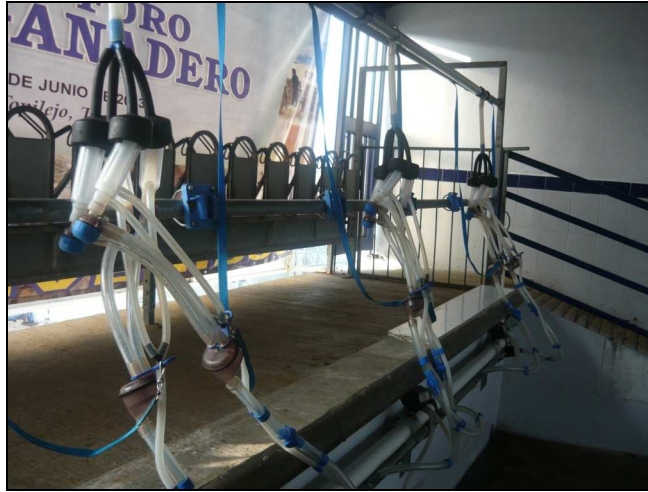
Figura 8. Sala de ordeño de tipo parada convencional
