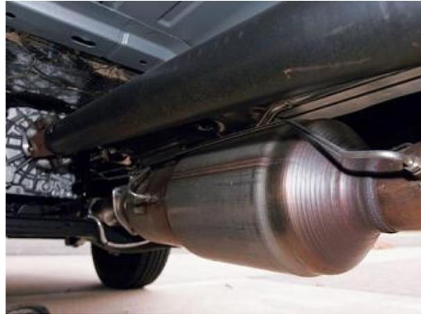
Figura. 4.11 Convertidor catalítico de un tractocamión.
