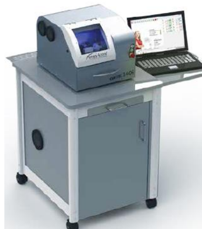
Figura 11 Fresadora CORiTEC 140i.
