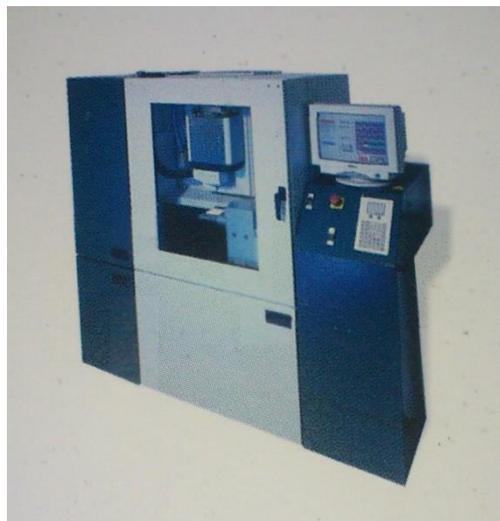
Figura 8 Máquina de fresado donde se envía la imagen para fabricarse el núcleo <sup>20</sup>
