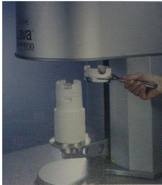
Figura 9 Horno de sinterizado de las coronas fresadas para lograr la resistencia final <sup>20</sup>.
