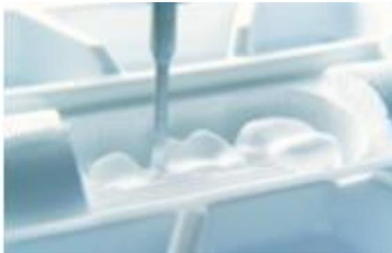
Figura 32 Se talla en un bloque de zirconia el diseño <sup>24</sup>.
