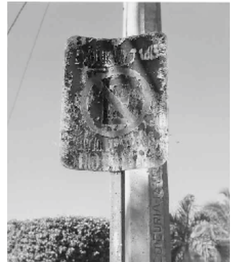
Señalamientos dañados por el clima tropical (Fig.41)
