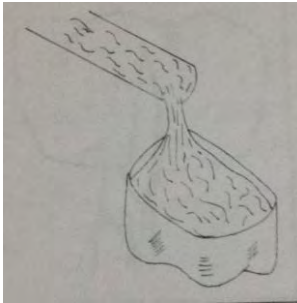
FIGURA 9 SE LLENA LA CORONA CON EL CEMENTO.
