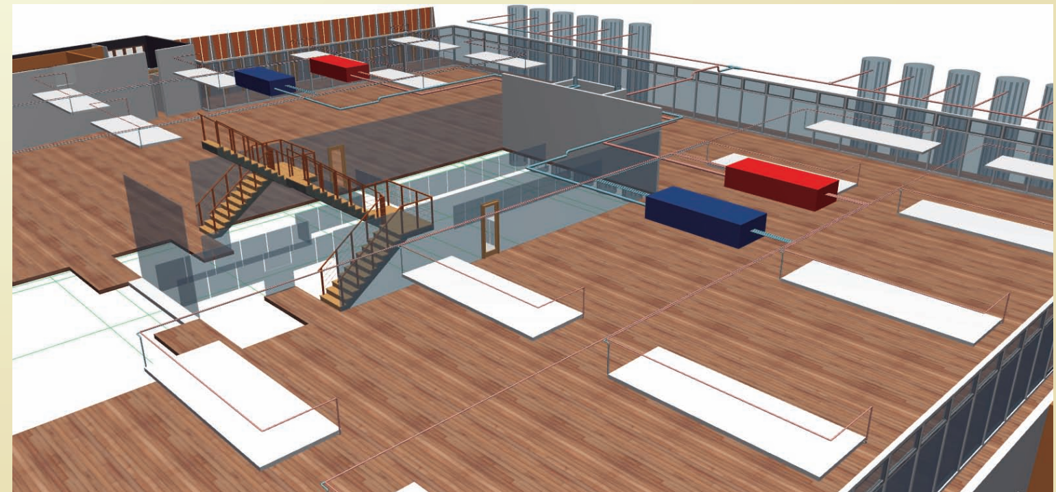
Perspectiva del arreglo de los paneles frios y sus tuberías (segundo piso).
