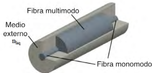
Figura 2.10. Diagrama esquemático del sensor refractométrico con estructura monomodo-multimodo-monomodo [22].
