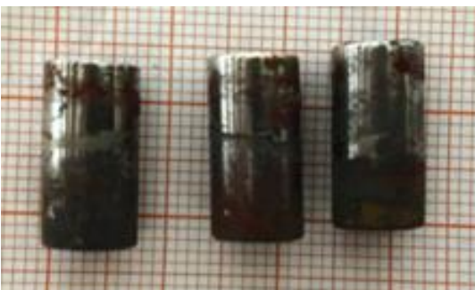
Figura 5.15. Mismas probetas que en la figura 5.14 esta vez enjuagadas. Se observa un rastro grisáceo en el lugar donde se colocó la liga.
