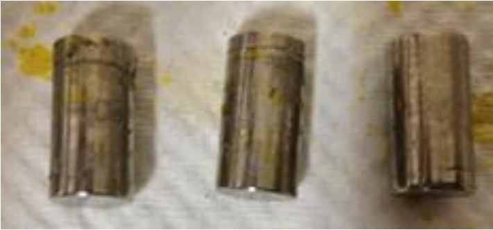
Figura 5.13. Probetas ensayadas a temperatura ambiente. No se aprecia rasgos de corrosión localizada.
