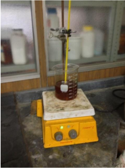
Figura 4.2. Arreglo para hacer el ensayo de la norma ASTM G-41 a 50°C.
