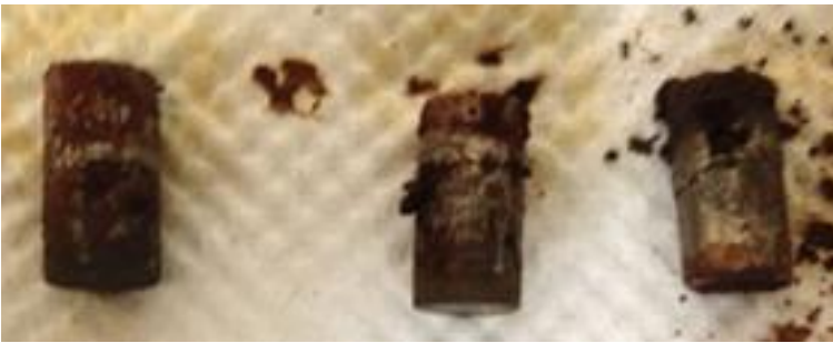
Figura 5.14. Probetas ensayadas a una temperatura alrededor de 60 °C, se aprecian precipitados de hematita comprobados en la sección de resultados 5.1.
