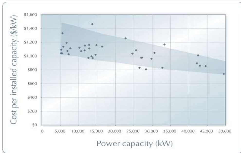
Figura 34 Costo de equipo y de instalación - Turbina a gas (5-50 MW)
