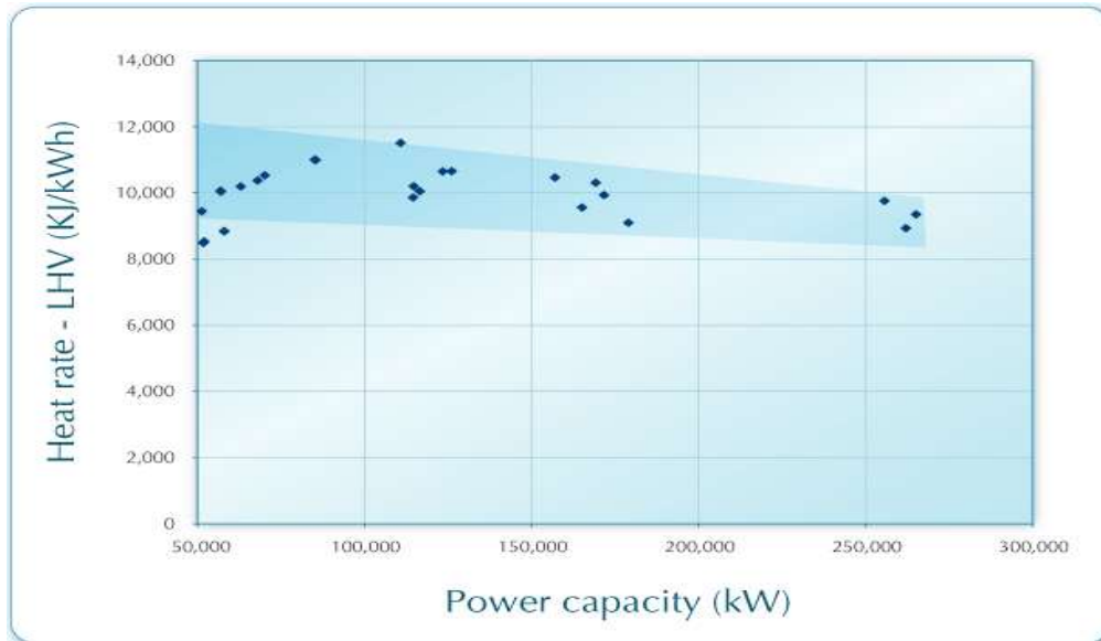
Figura 29 Rendimiento calórico para turbinas a gas con capacidad entre 50 y 300 MW
