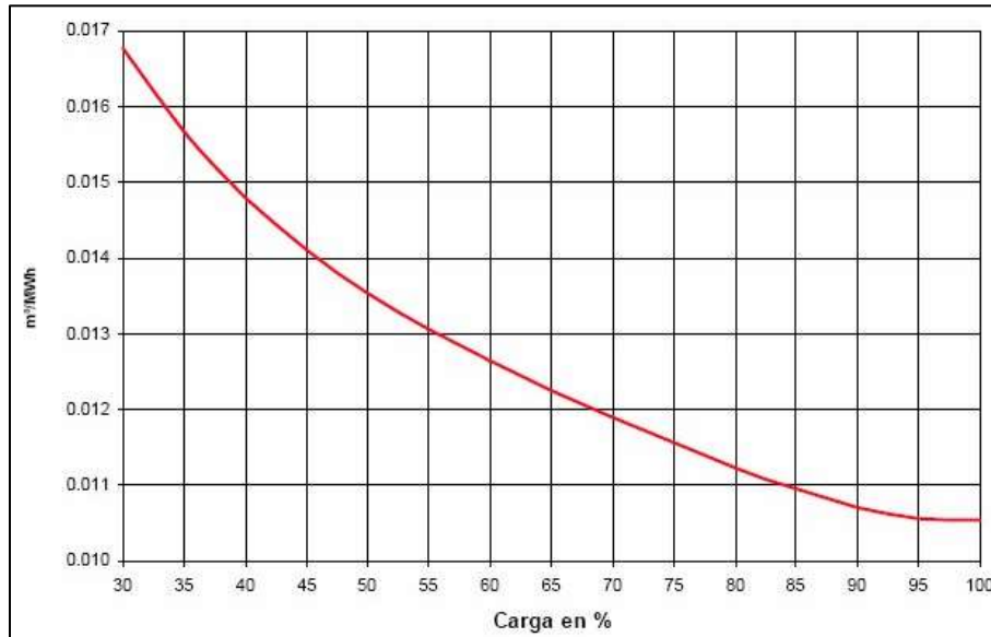
Figura 40 Consumo de agua de repuesto al ciclo vs carga en ciclos combinados
