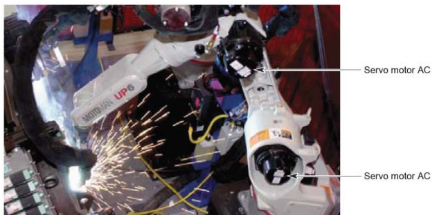
Figura 2.5 Este robot soldador industrial de alto desempeño utiliza dos servo motores de corriente alterna para proporcionar movimiento al brazo. Motoman Robotics Europ AB.
