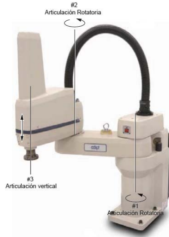
Figura 2.19 Configuración de robot SCARA. Resaltando sus dos articulaciones rotatorias y una sola articulación vertical en esta configuración horizontal. (Adept Technology, Inc.)
