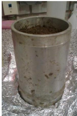
Figura 3.4 Columna de suelo intacta
