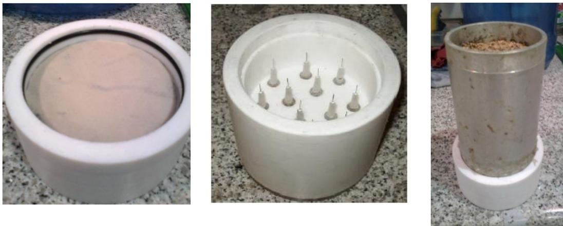
Figura 3.5 Base de columna preparada (izquierda), simulador de lluvia (centro) y columna montada en la base y con granos de arena fina en la parte superior (derecha).
