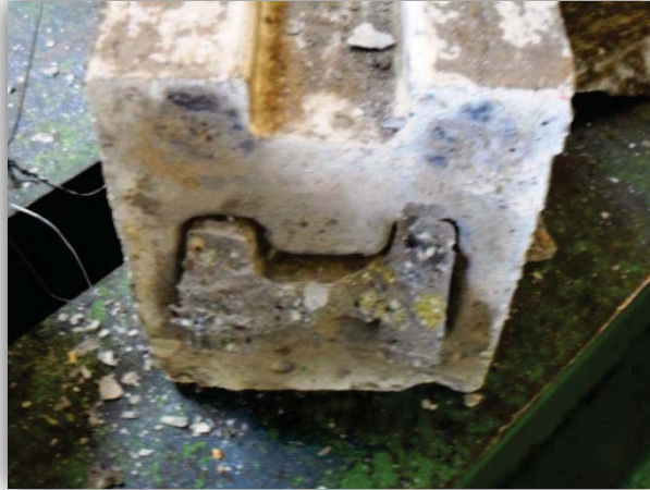
Botón fracturado de la pieza con la cual existía ensamblaje.
