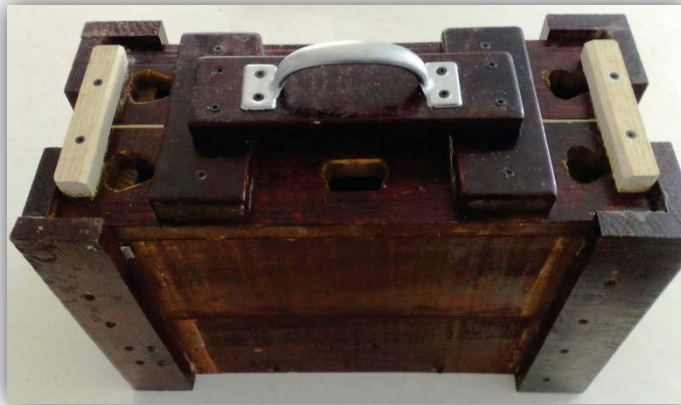
Molde ensamblado para el colado de las piezas.
