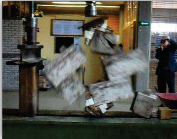
Instante en que el murete colapsó.
