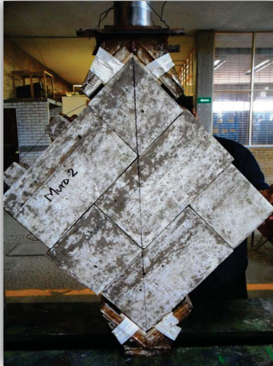
Colocación del murete.
