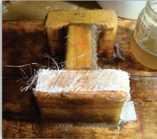
Colocación de la primera capa de fibra de vidrio, fuera del molde.
