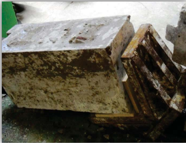
Block de contacto con el cabezal inferior, muestra que sus botones de ensamblaje fueron fracturados.
