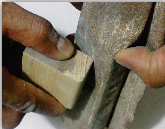
Desbaste en las esquinas de la pieza.
