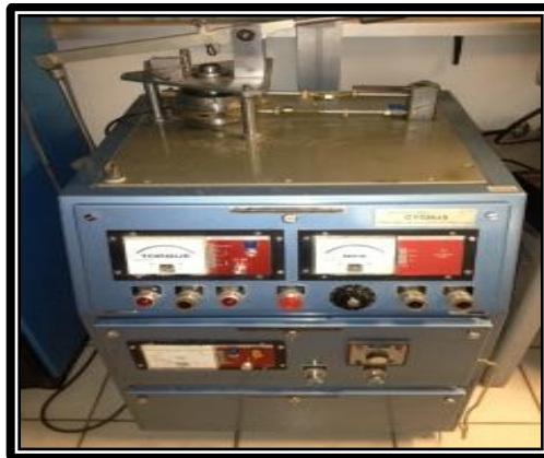
Figura 33. Equipo de desgaste y fricción.
