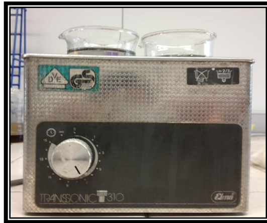
Figura 24. Equipo de limpieza ultrasónica
