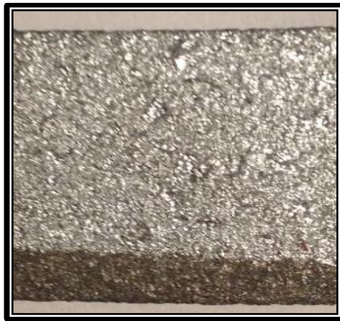
Figura 37. Imagen del recubrimiento AlZn-SiC 20segundos/20 boquilla.
