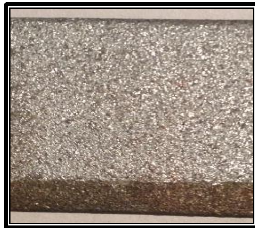
Figura 36. Imagen del recubrimiento AlZn-SiC 20 segundos/18 boquilla.
