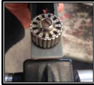
Figura 26. Sistema de apertura de boquillas número 16 y 18.
