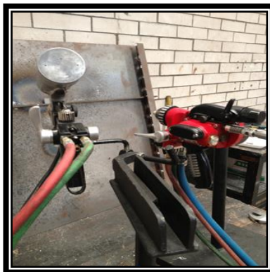
Figura 28. Equipos de proyección térmica.
