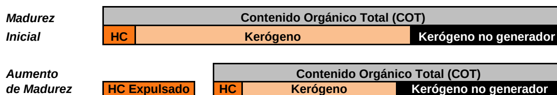
Fig. 2.16 La madurez y expulsión produce una reducción de kerógeno y COT dada la cantidad de carbono expulsado como aceite y/o gas. (Modificada de Jarvie, D.,1999).
