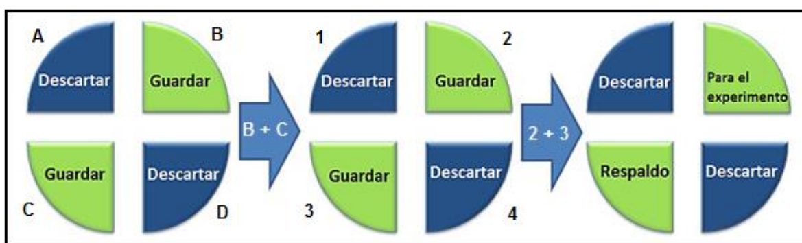
Fig. 5.21 Muestra el proceso de división en cuatro partes de las muestras. (Modificada de Society of Petroleum Engineers, 2013).
