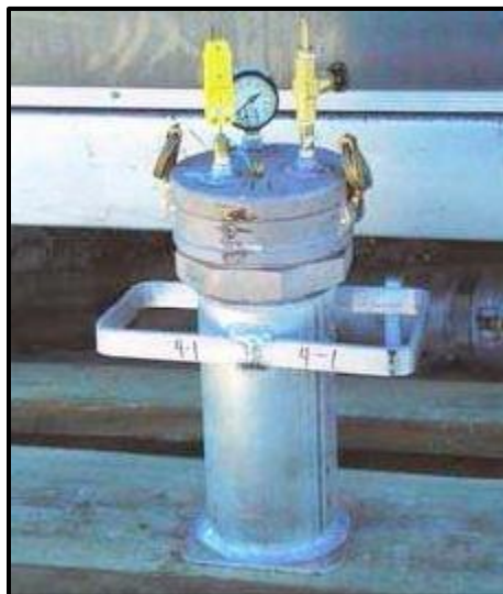
Fig. 4.7 Aparato canister usado para medir el contenido de gas total en muestras trituradas. (Tomada de Weatherford, 2010).
