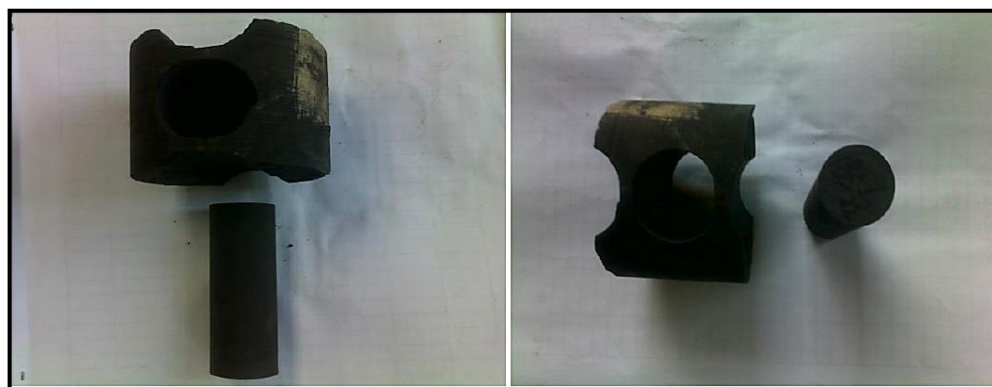
Fig. 5.22 Núcleos listos para los experimentos de medición de propiedades de la lutita. (Tomada de Society of Petroleum Engineers, 2013).
