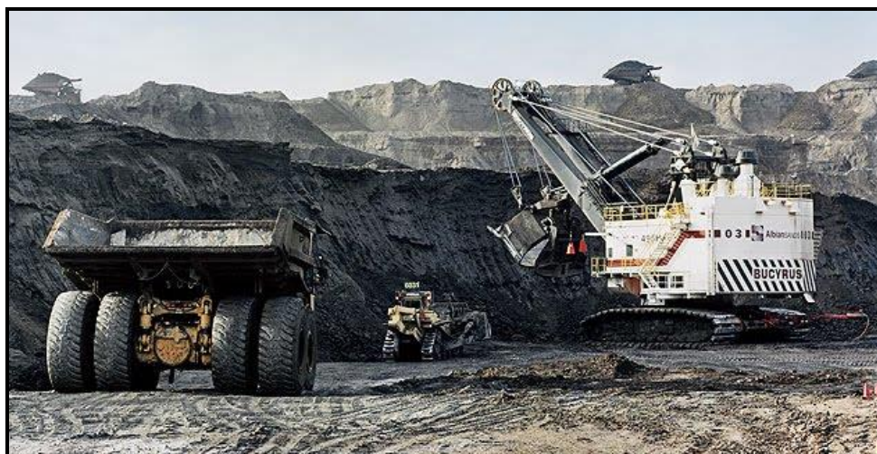
Fig. 1.17 Extracción de arenas bituminosas mediante minería. (Tomada de Hernández, J.A., 2011).
