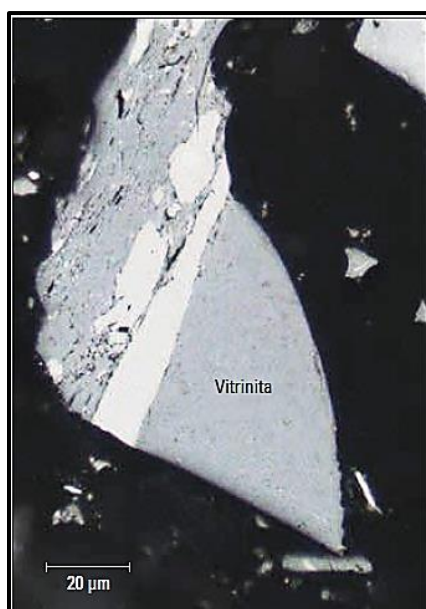
Fig. 3.49 La vitrinita en una muestra. La cantidad de luz reflejada por los macerales de la vitrinita constituye una prueba clave para determinar la madurez térmica de una roca. La intensidad de la luz reflejada se mide en cientos de puntos, a lo largo de un área de muestreo microscópica. (Tomada del Programa de Recursos Energéticos del Servicio Geológico de EUA, 2011).
