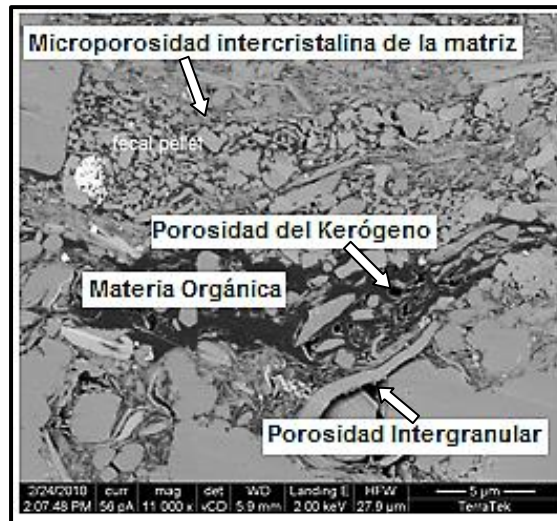
Fig. 2.24 Tipos de porosidad presentes en las lutitas gasíferas. (Modificada de Quirein et al, 2011).
