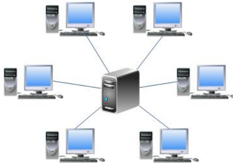
Figura 1. 3 Topología típica en estrella.
