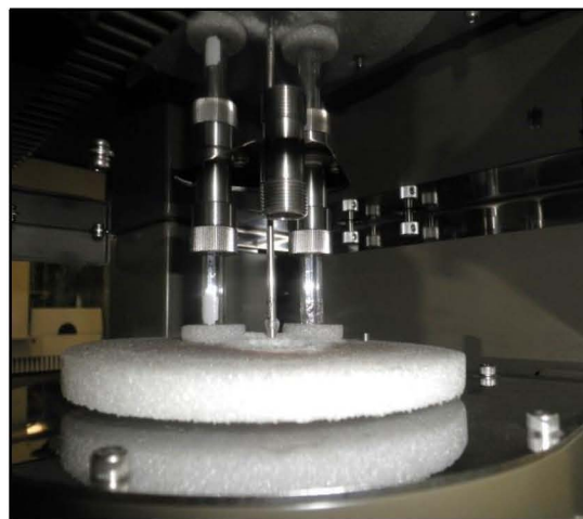
Fotografía 6-37.- Analizador Bel Sorp Mini II
