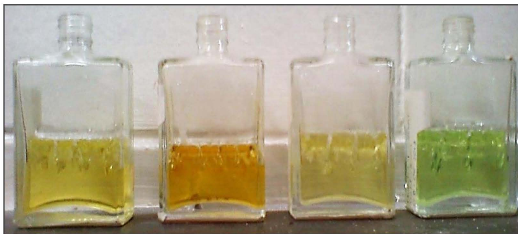
Fotografía 6-13.- Muestras geladas, eliminando el exceso de componentes
