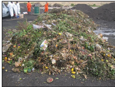
Figura 2. Muestreo de residuos orgánicos. Método de cuarteo realizado en la Planta de Composta de Bordo Poniente, Distrito Federal.
