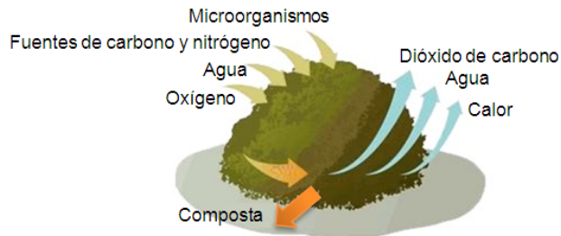
Figura 8. Esquema del proceso de compostaje (Komilis & Ham, 2004).
