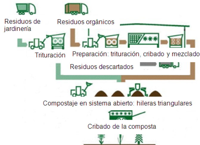
Figura 9. Esquema típico de un proceso de compostaje en sistema abierto (KOMPTECH,2012).
