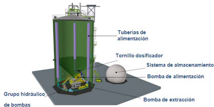
Figura 15. Esquema de un reactor vertical de digestión anaerobia seca, tecnología Dranco (De Baere, 2013).
