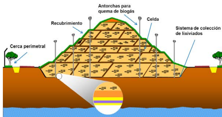
Figura 17. Corte esquemático de un relleno sanitario (Chávez Gasca, 2013).
