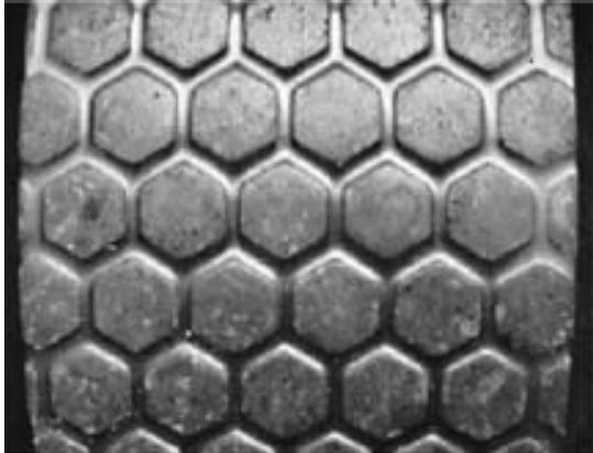
Tanto Polysius como KHD han experimentado con aplicaciones de minerales y rodillos tachonados y pueden proveer equipos con capacidades de hasta 2,200 tph. Aunque Köppern tiene experiencia limitada en operaciones de procesamiento de minerales, sus equipos son operados satisfactoriamente en la industria del cemento. Para materiales altamente abrasivos, Köppern recomienda emplear su protección tipo Hexadur en los rodillos.
