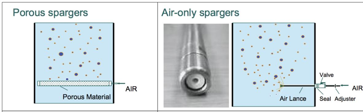
**Figura 3.16. Mecanismos de difusión de aire (Tomada de presentación Optimizing the Process with Metso CISA de Metso)**
