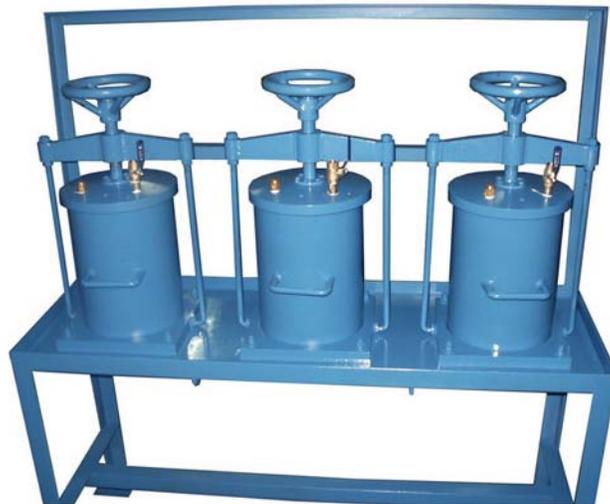
Figura 4.25. Filtros de laboratorio (Tomada de <http://www.vymasa.com/es/laboratorios-mineros>)
