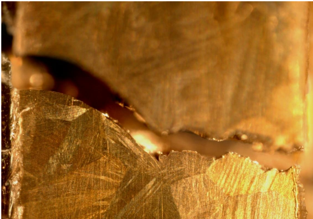
Figura 3.21. Fractura inter-granular de la muestra C4
