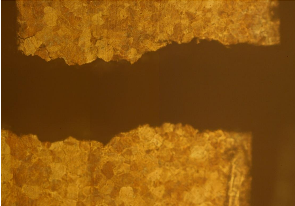
Figura 3.25 Fractura de una probeta aleada (Cu-Al-Ni-2%Mn-1%Nb)
