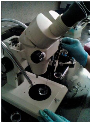
Figura. 18. Micro-inyección in vitro del mRNA mediante un manipulador fijo y un microinyector.
