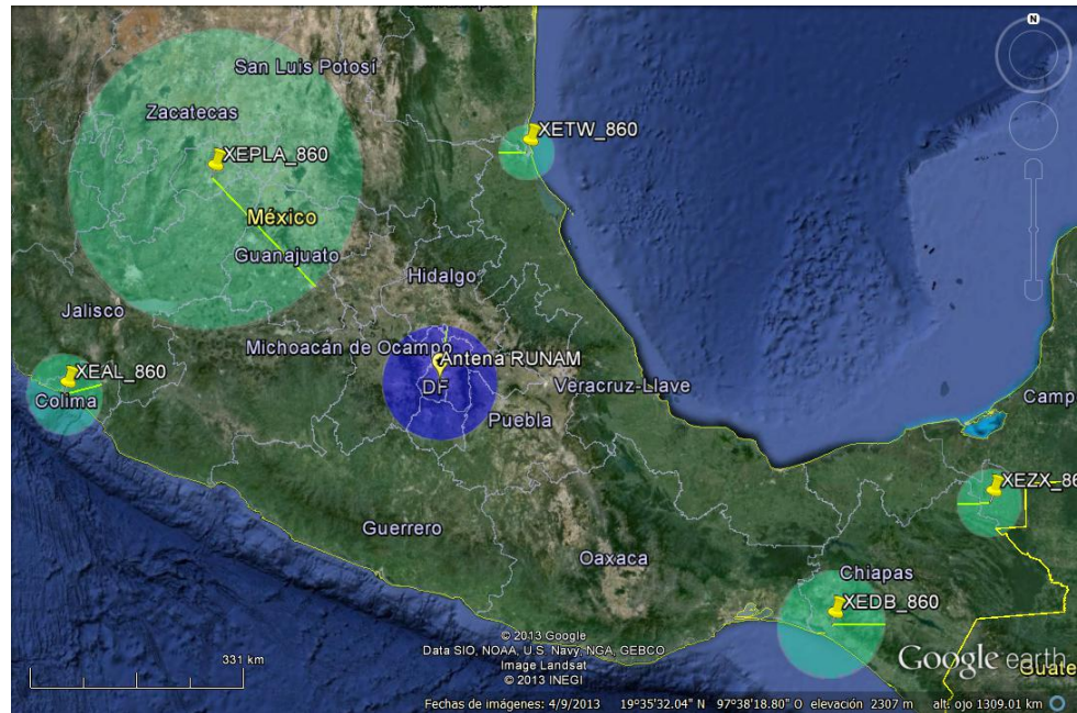
Figura 6.12: Contorno Protegido Cocanal Nocturno de Radio UNAM ( 50[kW] ) y Contornos Interferentes Cocanales Nocturnos de las demás estaciones.
