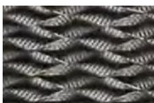
Cada capa de este empaque tiene huecos a través de los cuales el vapor asciende. El líquido fluye sobre la superficie del material en su ruta descendente hacia el fondo de la torre.
