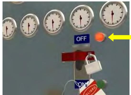
Este aislamiento impide la liberación de energía y materiales peligrosos, de máquinas, instalaciones y equipos de procesos mediante la desconexión, cierre y junta cegada de válvulas, remoción de secciones de tubería y desconexión de mecanismos.
