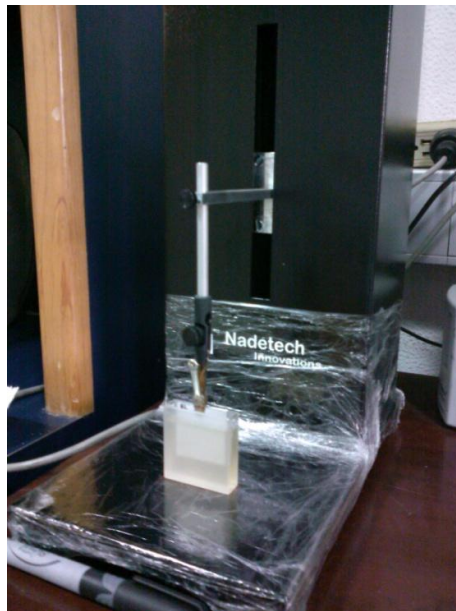
Fig.3.4. Equipo utilizado para inmersión de las placas en sol-gel.
