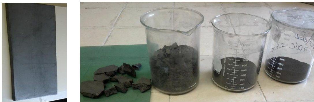
Fig.3.1. De izquierda a derecha: a) Placa de grafito inicial, b.1) y b.2) grafito en trozos, c) grafito molido y d) grafito tratado térmicamente.
