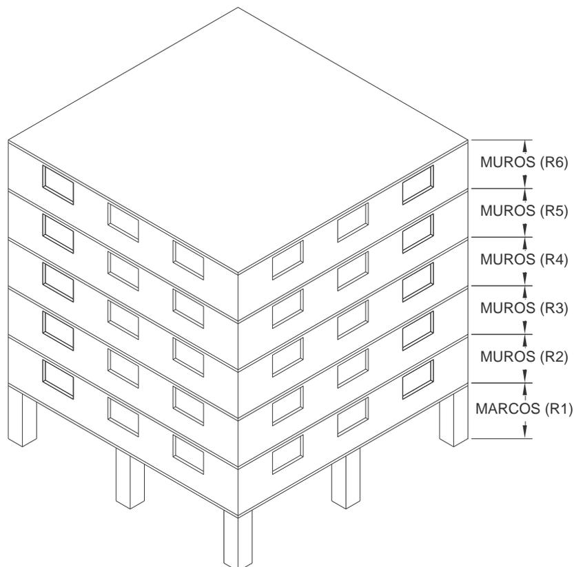
Alguna alternativa para equilibrar las rigideces comúnmente es la colocación de muros estructurales en la planta baja, acomodados estratégicamente para disminuir los efectos de torsión, estos pueden ser de ladrillo convencional, de alta resistencia o concreto según lo requerido.
