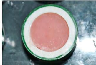
Figura 4. Muestra embebida en resina acrílica
