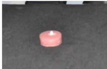
Figura 13. Ejemplar de la muestra elaborada con ionómero de vidrio
