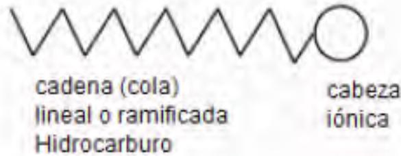
Fig. 2.11. Diagrama de una molécula de surfactante.
