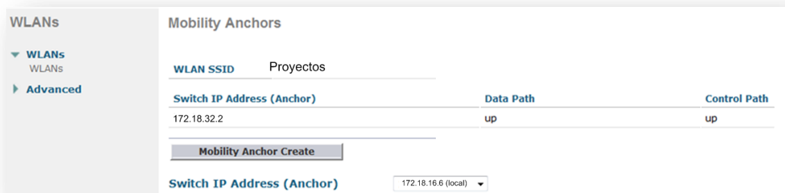
Figura 5.36 Anclaje de la red WLAN Proyectos del WLC Foráneo B
