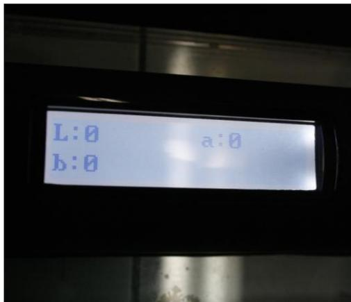
Fotografía 11 Colorímetro Chinespec®, HPG-2132, China calibrado previamente con una hoja
