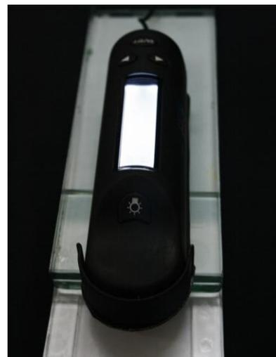
Fotografía 10 Colorímetro Chinespec en posición para medir los valores del sistema CIE  $L^*a^*b^*$
