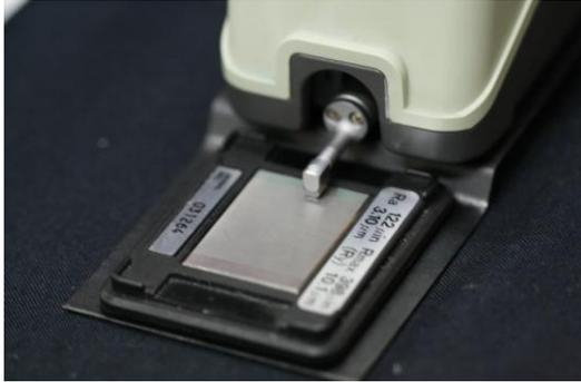
Fotografía 7 Calibración del perfilómetro Mitutoyo, para la lectura de rugosidad en el esmalte.
