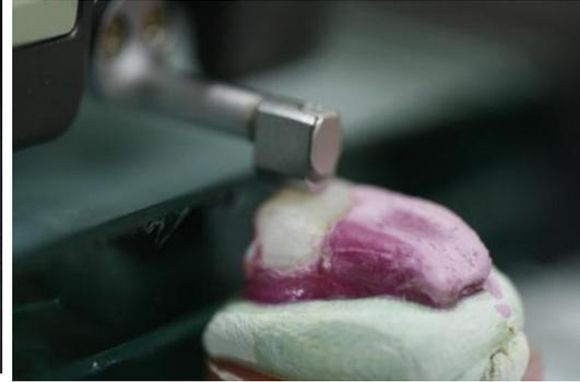
Fotografía 8 Lectura de rugosidad en un punto específico del diente.
