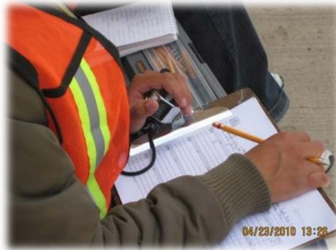
Figura 21. Aforador de campo utilizando contador manual
