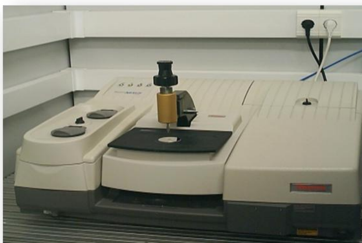
Figura 2.9 Equipo utilizado para la identificación de compuestos a través de su espectro.
