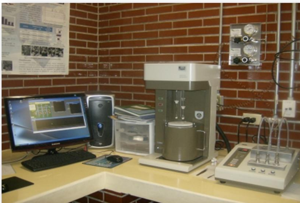
Figura 2.6 Equipo utilizado para determinar las isotermas de adsorción con N_2 , en la esquina inferior derecha, equipo Belprep-Flow y en la parte central equipo Bel minisorp II.
