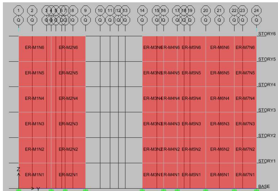
Figura 29. Ejemplo elevación muros y nombres asignados a los muros por piso dirección Y.
