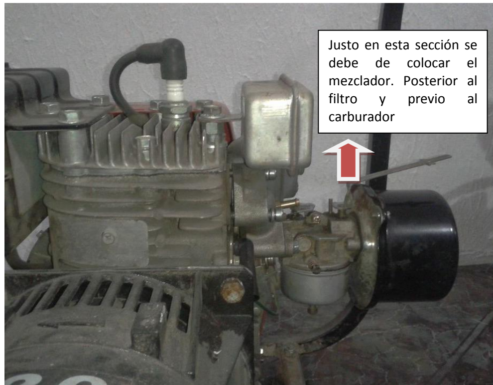
Figura 4.14 Lugar en el que se debe de colocar el mezclador biogás-aire para la conversión
