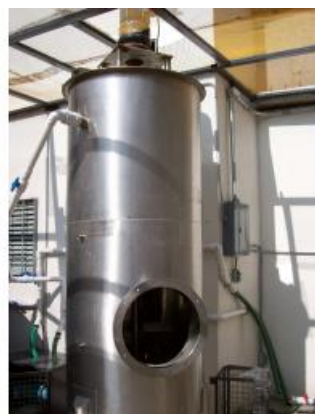
Figura 4.5 Tanque digestor (Juárez, 2012)
