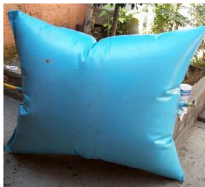
Figura 4.9 Bolsa contenedora de biogás (Juárez, 2012)
