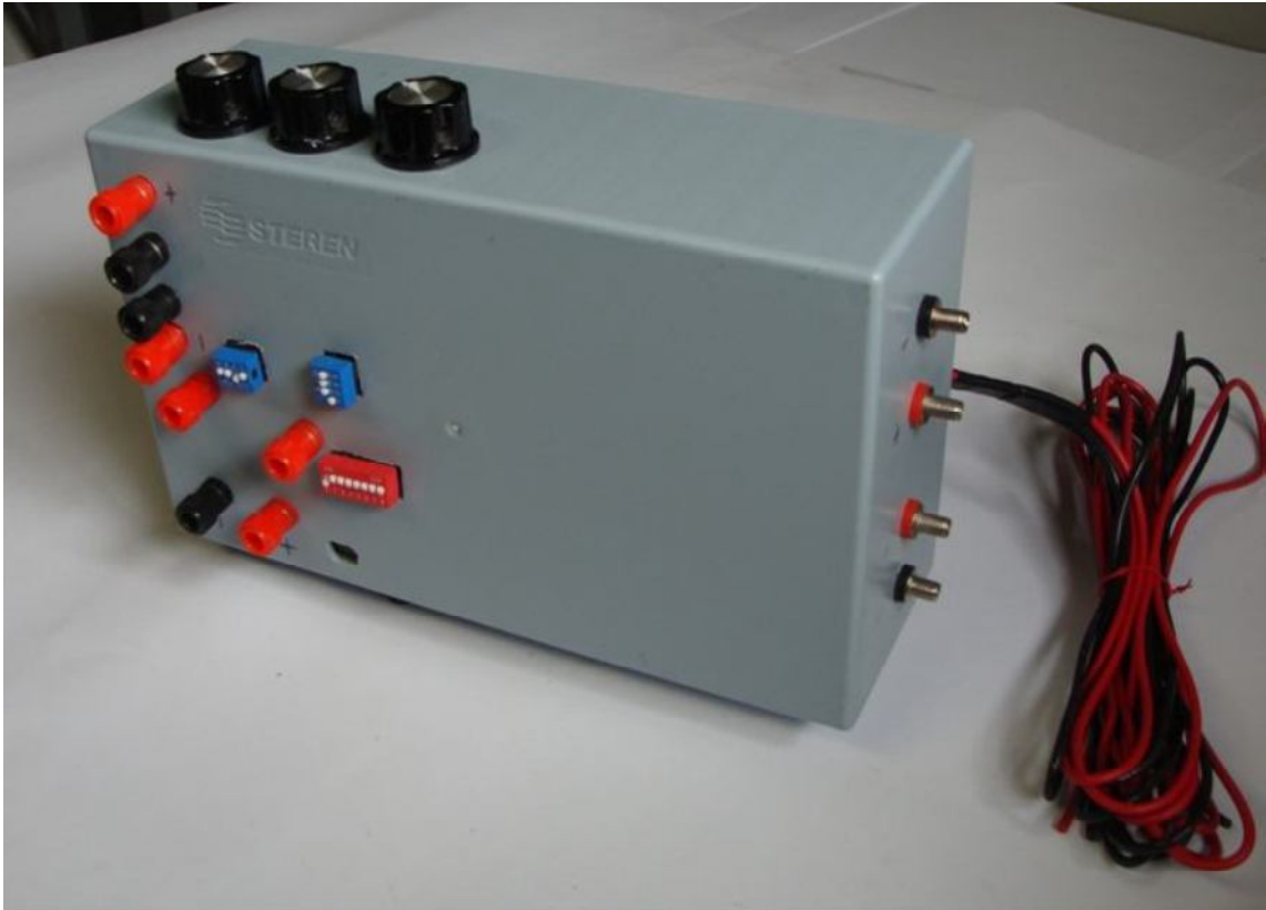
Fig. 3.24. Equipo transmisor óptico de 16 canales (Fotografía)
