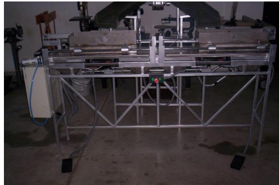
Figura 3.23. Sistema real de pesado y dosificado de totopos
