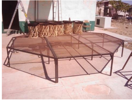
Figura 3.19. Dispositivo para estirar y secar el cuero de vaca
