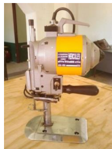
Figura 3.18. Equipo para cortar cuero (piel seca) de vaca
