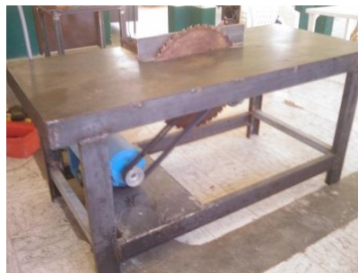
Figura 3.17. Equipo para cortar madera de 5" a 6" de diámetro
