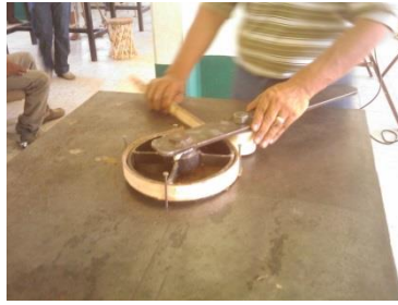
Figura 3.15. Dispositivo para formar los aros
