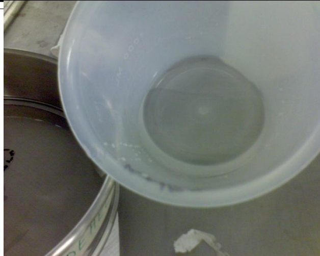
Figura A15.4 Filtrado de la suspensión de la corrida 5 en malla 100
