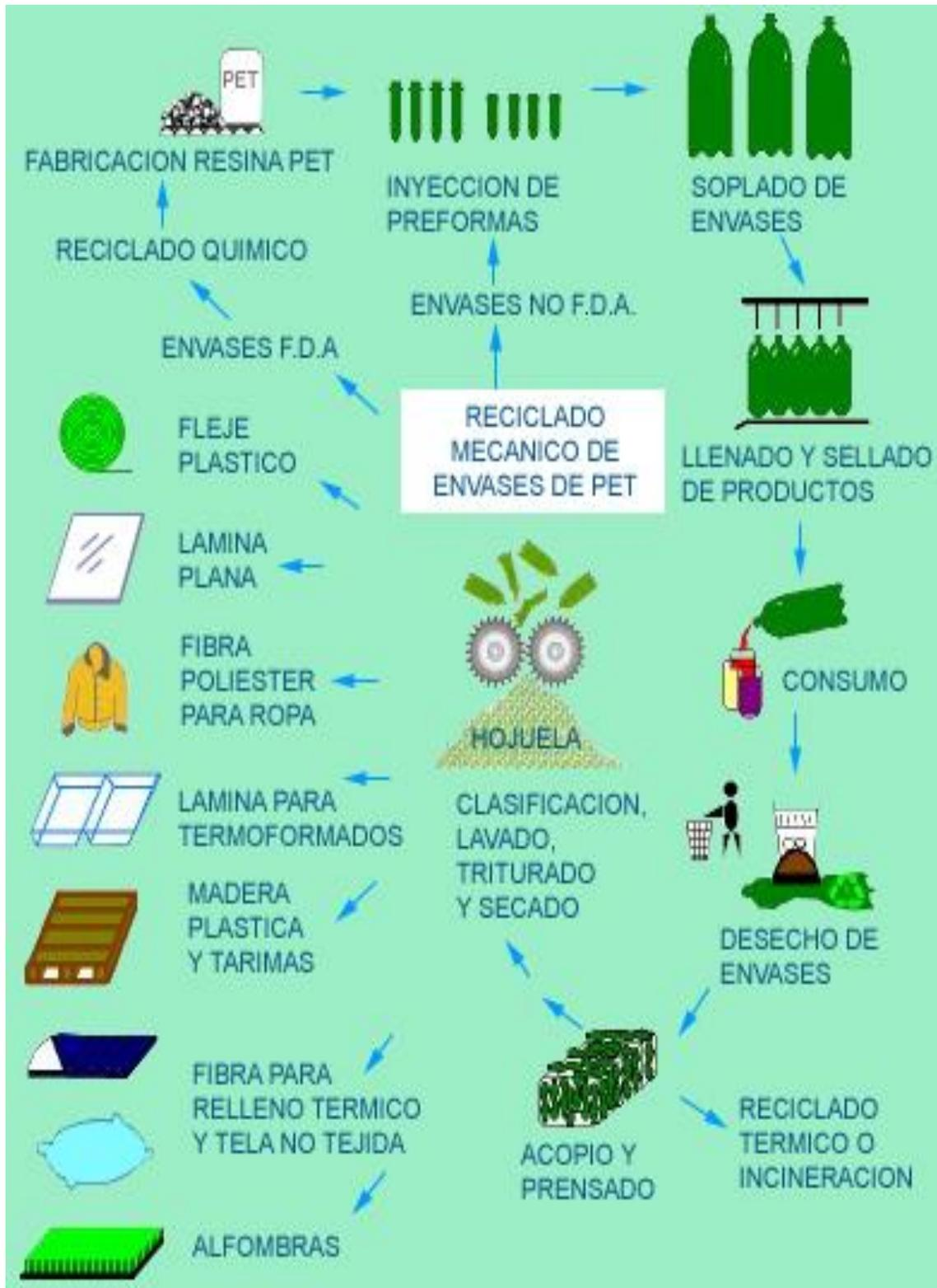
Figura 1.1. Proceso de reciclado mecánico. Fuente [www.plastico.com](http://www.plastico.com)
