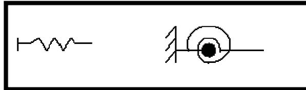
Ilustración 2.21. Resortes de rigidez lineal y rigidez angular.
