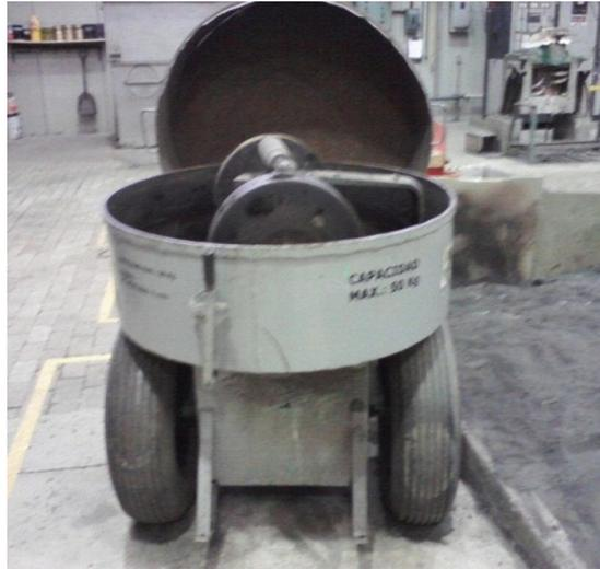
Figura 3.6 Molino Chileno para la preparación de arena para moldeo en verde.
