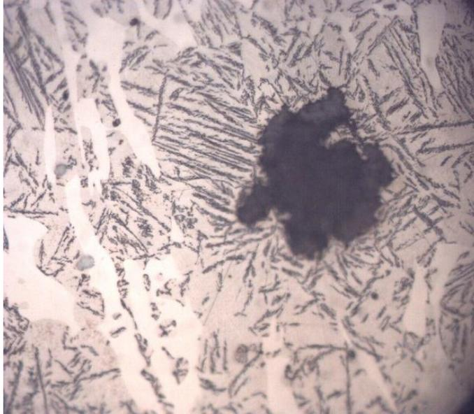
*Figura 4.32 Detalle microestructural del hierro CAD austenizado a 910 °C durante 120 minutos, y austemperizado a 375 °C por 60 minutos; Atacada con Nital al 2%, tomada a 1000X.*
