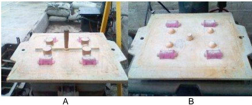
Figura 3.4 Placa modelo con base a línea de partición (LP).
