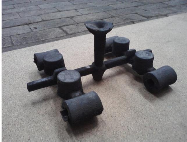
*Figura 3.7 Piezas prototipo de CDI (Carbídico Ductile Iron) incluyendo el sistema de colada.*
