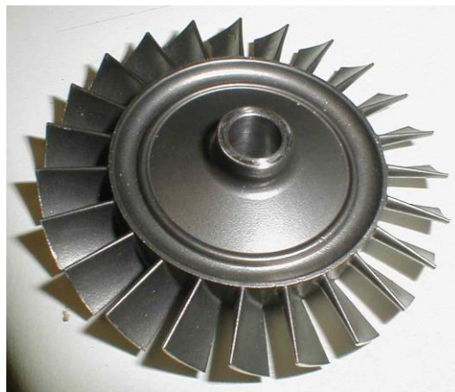
Figura 6. Estructura del disco de una Microturbina de gas (Arreglo de alabes de trabajo)
