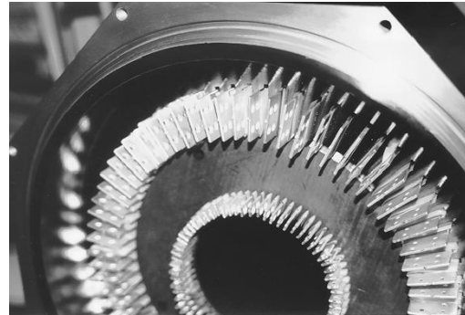
Figura 9.6. Estator del prototipo con las barras de cobre del bus. Se utiliza Teflón® como guía para las ranuras.
