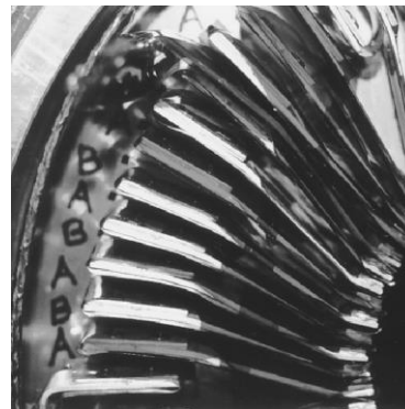
Figura 9.7. Acercamiento de las piezas de cobre que se utilizan para interconectar los extremos finales de las bobinas del estator.
