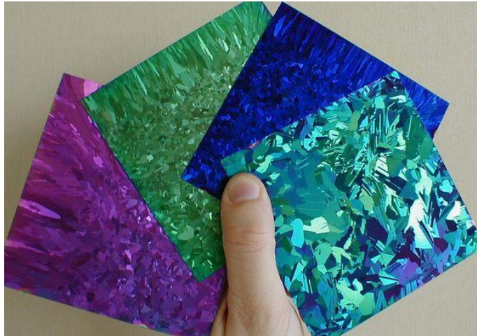
Figura 2.8 Distintas cubiertas anti reflectantes de nitruro de silicio. El color depende del grosor de la celda pero es únicamente utilizado como referencia [19]
