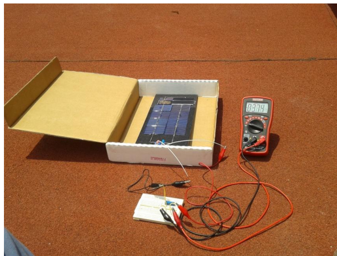
Figura 4.4 Montaje del experimento para la determinación de la eficiencia del panel con el Sol
