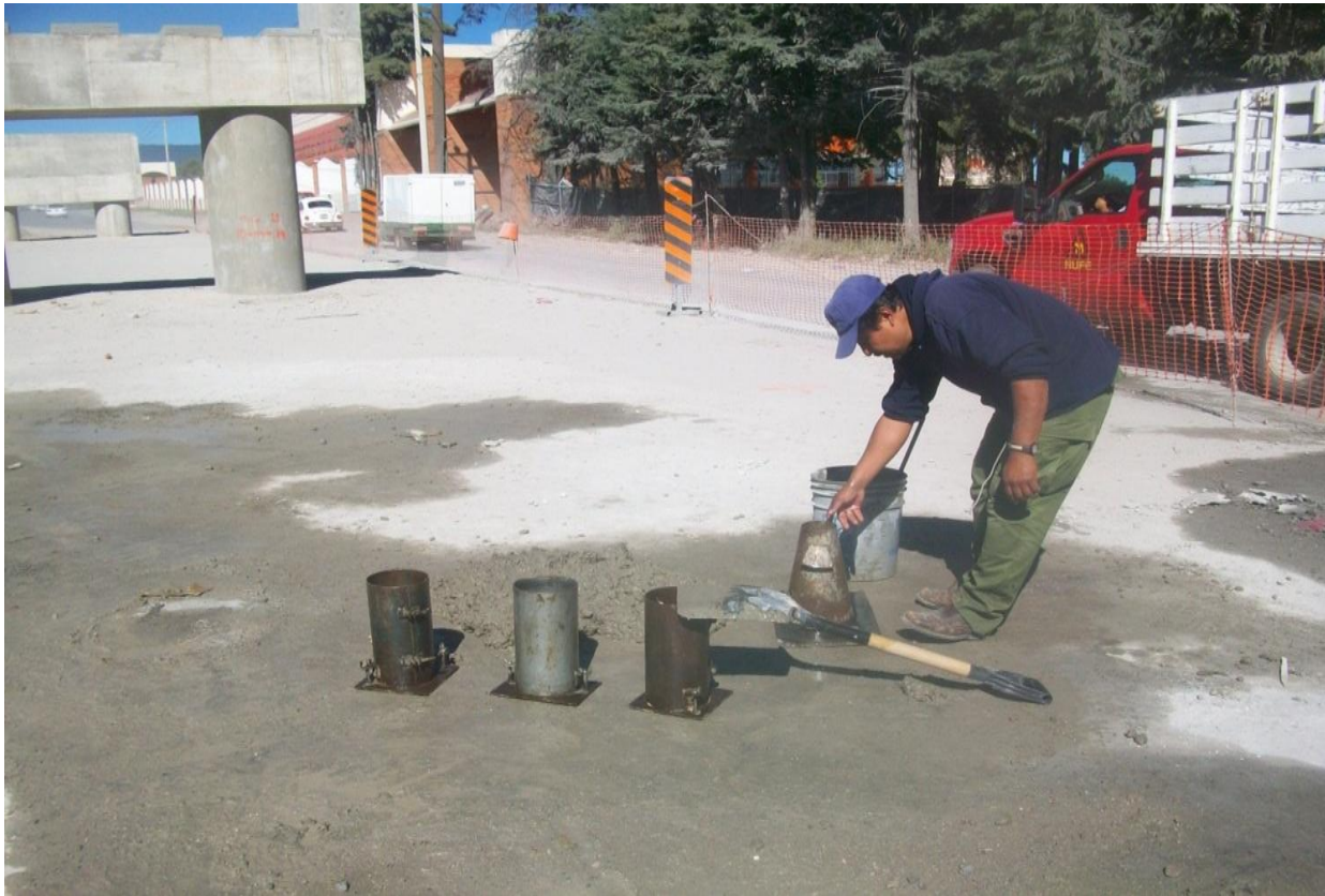
Fig. III.1 se puede observar como el control de calidad obtiene sus muestras del concreto
