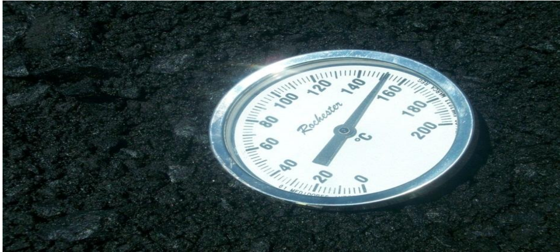
Fig. II.5.7 Se tendió asfalto a temperatura arriba de 140°C.
