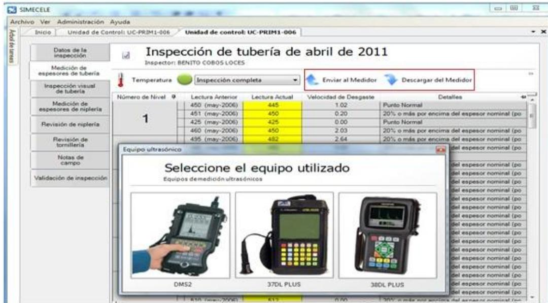
Figura 3.29. Envío y descarga de datos de equipos de medición ultrasónica
